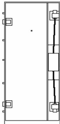
(1) Hauteur maximale de 2450 avec installation obligatoire d'une troisième paumelle et supplément de 20% sur le prix totale de la porte hors standard.
